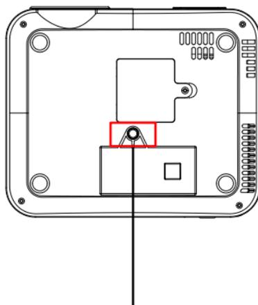
Orificio roscado de 1/4 (6,35 mm de diámetro)
